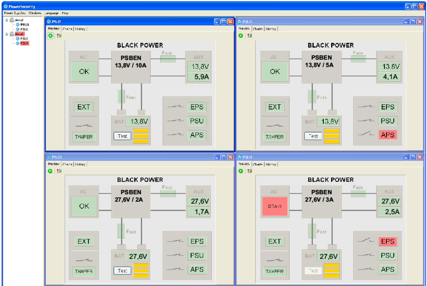
Fig. 14. „Power security” main panel.
